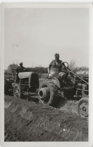
Der pløjes til aspargesbedet med 2 specialbyggede højre og venstre pløve monteret på en Farmall A traktor, årgang 1947.
